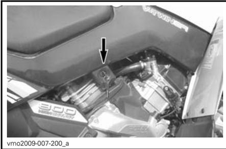
Le système antivol permet d'immobiliser le levier sélecteur à la position de stationnement.
