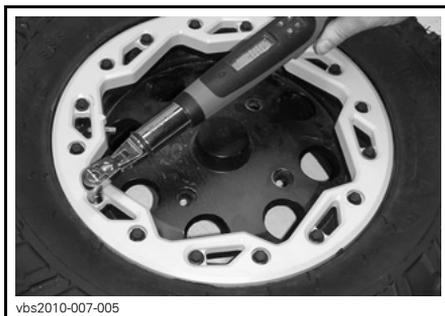
**NOTA:** É normal que o anel de aperto da trava de talão flexione ligeiramente para encaixar no talão do pneu.
