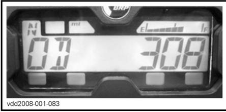
3. Pressione o botão seletor e SEGU-RE por 2 segundos. Isto mudará o modo exibido para Velocidade, RPM ou Combinado.
