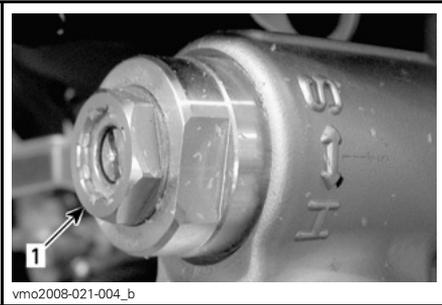
**TÍPICA****1. Compressão de amortecimento em alta velocidade**
