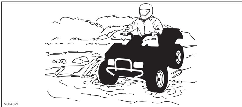
Wasser beeinträchtigt die Bremsleistung Ihres Fahrzeugs. Sorgen Sie durch mehrfaches Betätigen dafür, dass Ihre Bremsen wieder trocken werden, nachdem das Fahrzeug das Wasser verlassen hat.
