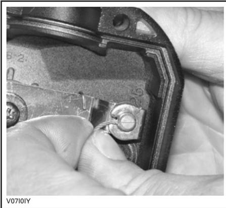
Entfernen Sie die Seitenabdeckung der Drosselklappe.
