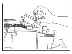
Remettre le bouchon de remplissage en place et bien le serrer. Remettre en place le capot moteur.
