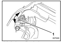
1. Levier de verrouillage de relevage
