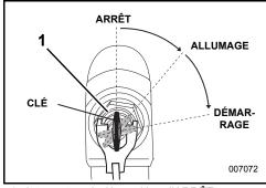
1. Interrupteur à clé, position d'ARRÊT
