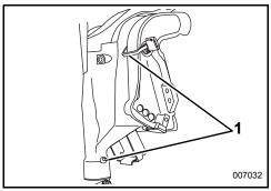
Points de lubrification du levier de relevage et du support pivotant (tous les ans)
