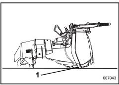
Transport du moteur hors-bord reposant sur les tampons amortisseurs
