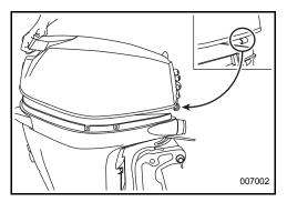
Retirer le bouchon de remplissage et remplir le réservoir d'un lubrifiant pour moteur horsbord recommandé comme indiqué dans **Spécifications d'huile** page 19.
