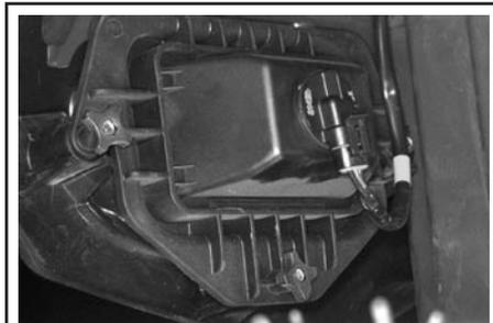
Tourner la douille de l'ampoule dans le sens antihoraire puis retirer le phare.
