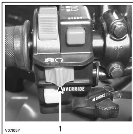
1. Interrupteur d'arrêt du moteur
