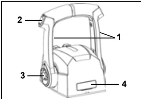
1. Palanca de cambios y acelerador
