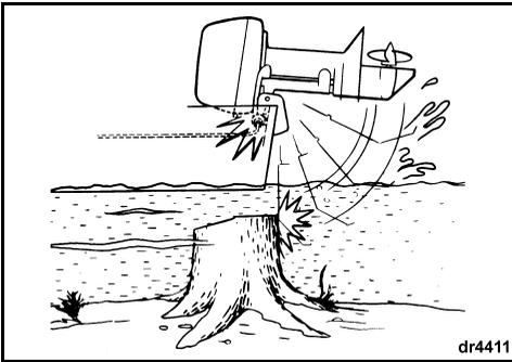
El sistema amortiguador del motor fueraborda no funciona marcha atrás. Si maniobrando marcha atrás choca con un objeto, ya sea en el agua o al remolcar la embarcación, ésta y el motor fueraborda pueden sufrir graves daños.
