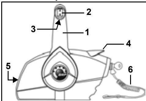
1. Palanca de cambios y acelerador
