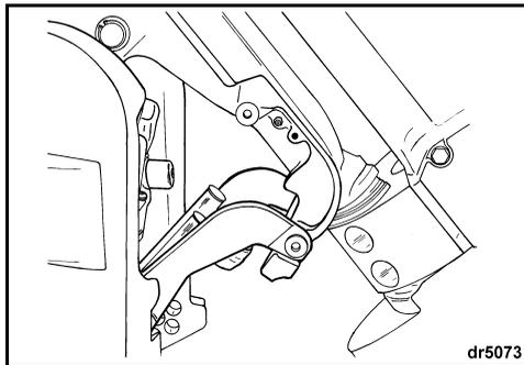
**Para desenganchar el soporte** — Incline el motor fueraborda completamente hacia arriba. Vuelva a colocar el soporte para remolcado en su posición de almacenamiento. Baje el fueraborda a la posición vertical.
