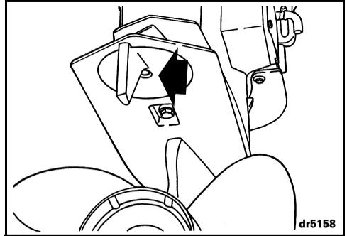
Apriete el tornillo de la aleta estabilizadora con un par comprendido entre 47 y 54 N·m (entre 35 y 40 pies libra).
