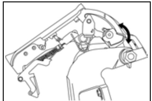
Cuando haya terminado de inclinar el motor, libere la palanca de bloqueo de inclinación:
