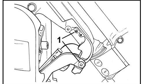
1. Modelos con elevación e inclinación automática, puntos de lubricación de soporte de remolcado y soporte giratorio (anualmente)
