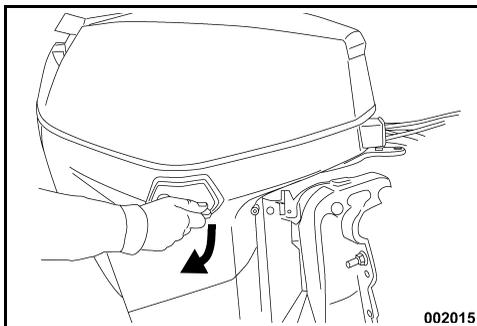
Suba la palanca de inclinación para soltar el retén de la tapa del motor.
