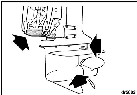
La corrosión galvánica destruye las piezas metálicas sumergidas y puede ocurrir en agua dulce o salada; sin embargo, el agua salada, salobre o contaminada acelera la corrosión.
