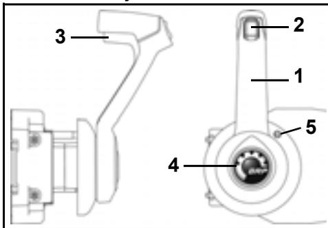
1. Palanca de cambios y acelerador
