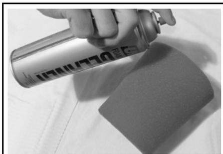
TÍPICA - PULVERIZE O ELEMENTO DE ESPUMA POR DENTRO E POR FORA
