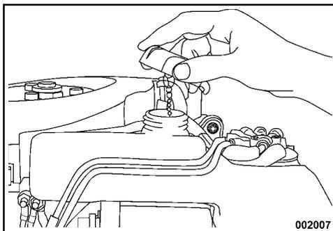
Remettre le bouchon de remplissage en place et bien le serrer. Remettre en place le capot moteur.
