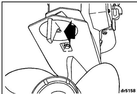
Resserrer la vis du compensateur de dérive à un couple de 47 à 54 N·m (35 à 40 lb·pi). Effectuer un essai du bateau et, si nécessaire, répéter l'opération jusqu'à ce que l'effort de direction soit aussi uniforme que possible.
