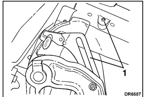
1. Points de lubrification (annuelle) du levier de relevage, de l'arbre du levier de relevage et du support pivotant
