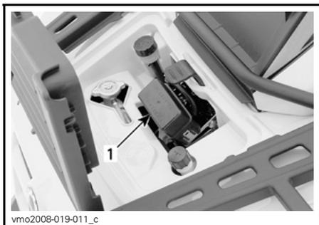
1. Vorderer Sicherungskasten
