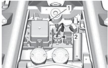
1. Vorderer Sicherungskasten
