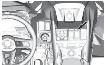
Mit diesem Schalter wird zwischen dem TRAIL-Modus (GELÄNDE) und dem MUD-Modus (SCHLAMM) gewechselt.
