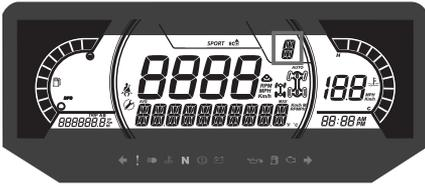
Diese Anzeige zeigt die Getriebestellung an:
