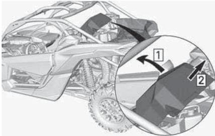
Entfernen Sie das CVT-Luftfilter vom Fahrzeug.
