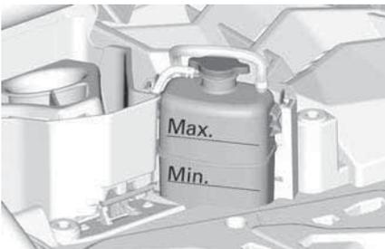
5. Geben Sie nach Bedarf Kühlmittel in das System. Mit einem Trichter vermeiden Sie das Verschütten von Flüssigkeit. **Nicht überfüllen.**
