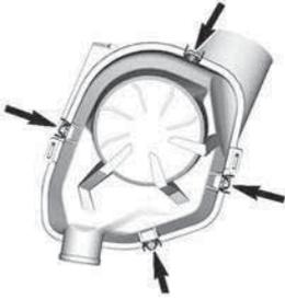
Entfernen Sie die Filterpatrone.
