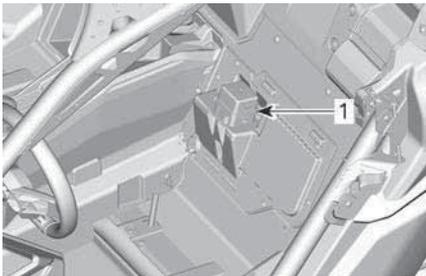
1. Hinterer Sicherungskasten
