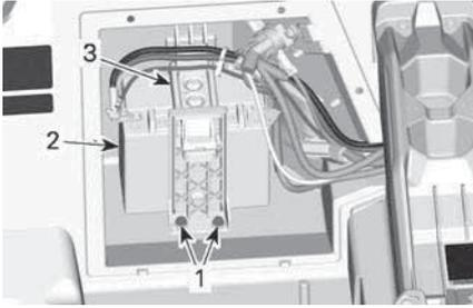
1. Halteschrauben des Batteriebügels
