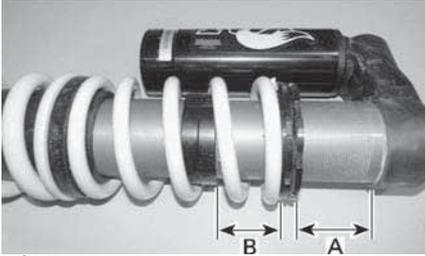
TÍPICO - AJUSTE DE LA SUPERPOSICIÓN - AMORTIGUADOR TRASERO
