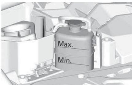
5. Añada refrigerante al sistema si es necesario. Utilice un embudo para evitar que se derrame. **No llene excesivamente.**
