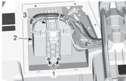
1. Tornillos de sujeción del portabaterías
