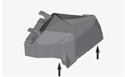
ELEVACIÓN DE LA PARTE TRASERA DE LA TAPA DE ACCESO
