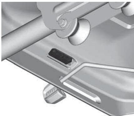
Tire hacia arriba de la parte trasera del cojín, y luego extráigalo del bastidor del asiento tirando de ella hacia atrás.
