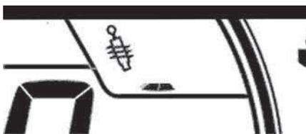
Cette icône apparaît et clignote lorsque vous avez la sélection du mode de suspension ou lorsqu'une erreur de suspension se produit.
