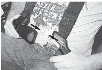
**Des deux côtés, ajustez la ceinture en l'appuyant fermement sur votre corps en tirant la longueur excédentaire de la ceinture abdominale vers l'intérieur. La boucle doit être centrée à la taille (aussi bas que possible).**
