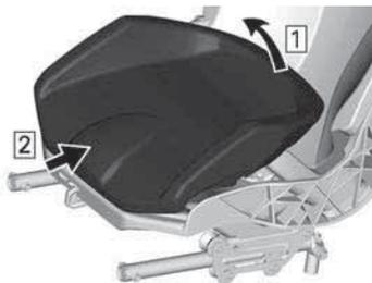
Pour le poser, inversez la procédure de dépose.
