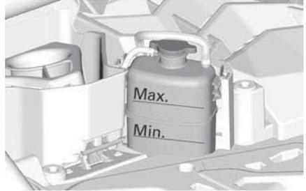
5. Ajoutez du liquide de refroidissement dans le système lorsque nécessaire. Utilisez un entonnoir pour éviter de renverser du liquide. **Évitez tout remplissage excessif.**
