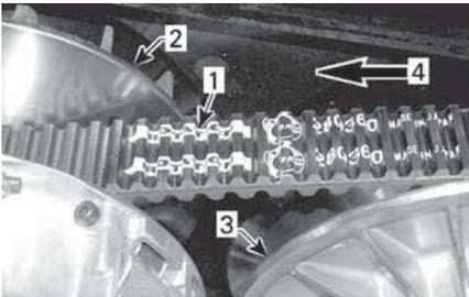
1. Flèche imprimée sur la courroie
