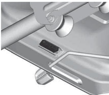
Soulevez l'arrière du coussin, puis dégagez le coussin du cadre du siège en le tirant vers l'arrière.
