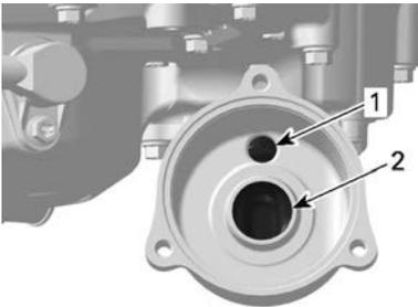
1. Orifice d'admission allant de la pompe à huile au filtre à huile
