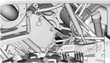
4. Placez un bac de récupération sous le bouchon de vidange du moteur.
