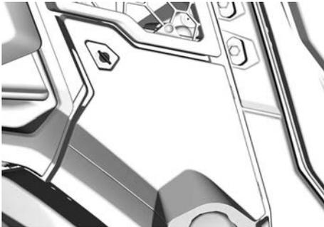
2. Ouvrez le boîtier du filtre à air et sortez le filtre à air.
