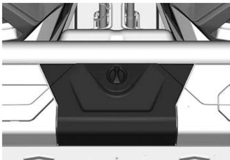
3. Vérifiez que le système de refroidissement est rempli jusqu'à la ligne de capacité maximale.
