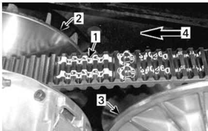
1. Flèche imprimée sur la courroie
