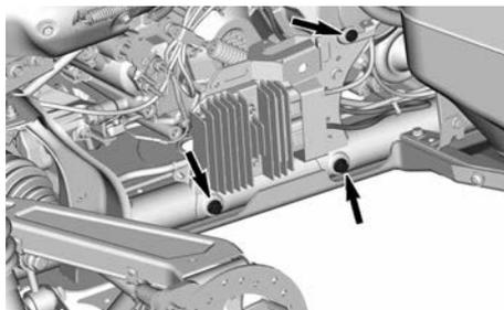
**VIS DE SUPPORT DE RÉGULATEUR/TENSION**
