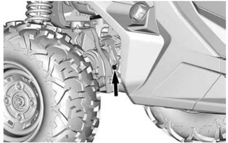
3. Retirez le bouchon de remplissage.
