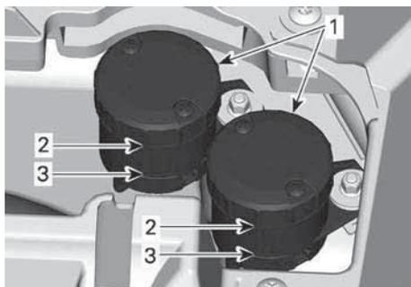
1. Depósitos de líquido de frenos
