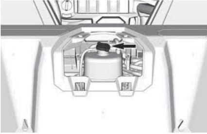
2. Añada refrigerante al sistema si es necesario. Utilice un embudo para evitar que se derrame. **No llene excesivamente el depósito.**
