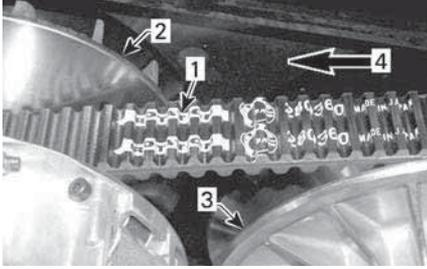
1. Flèche imprimée sur la courroie
