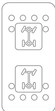
Le commutateur sélectionne le mode 2 roues motrices ou le mode 4 roues motrices lorsque le véhicule est arrêté.
