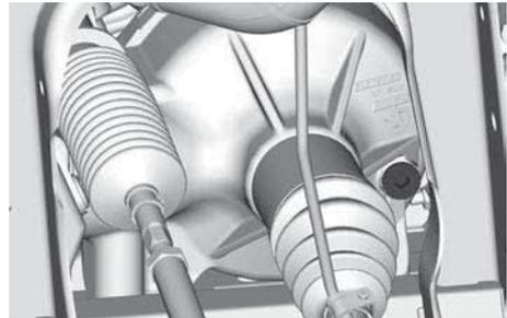
3. Retirez le bouchon de remplissage.
