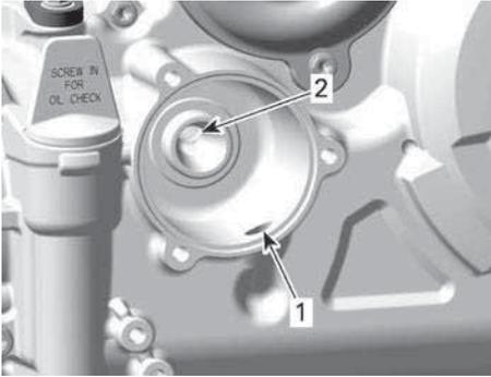
1. Orifice d'admission allant de la pompe à huile au filtre à huile
