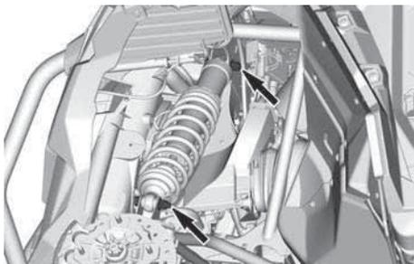
**SITUAZIONE TIPICA — DISPOSITIVI DI FISSAGGIO AMMORTIZZATORE ANTERIORE**
