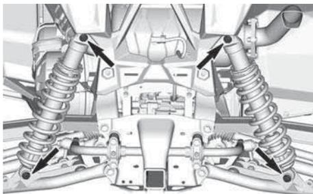
**SITUAZIONE TIPICA — DISPOSITIVI DI FISSAGGIO AMMORTIZZATORE POSTERIORE**
