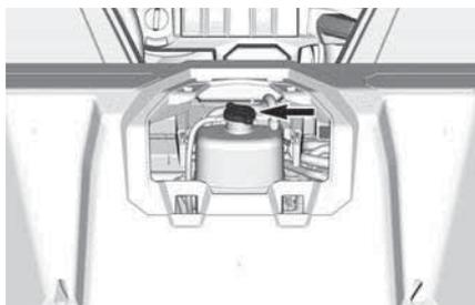
2. Aggiungere liquido refrigerante nel sistema se necessario. Usare un imbuto per impedire le perdite di liquido. **Non riempire eccessivamente.**
