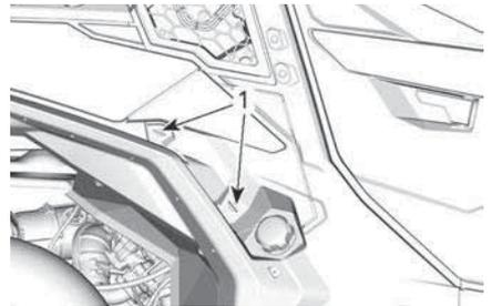
1. Girare i dispositivi di fissaggio di un quarto di giro
