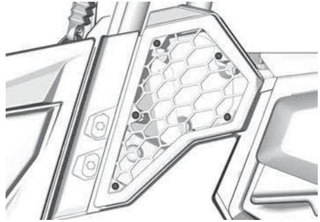
2. Rimozione del filtro dell'aria CVT.
