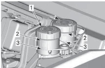
1. Depósitos de líquido de frenos
