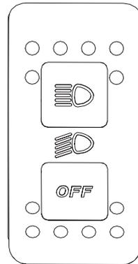
Con este interruptor se pueden seleccionar las posiciones de luces apagadas (OFF), luces cortas o luces largas.
