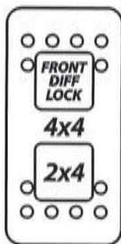
Este interruptor permite seleccionar el modo de tracción a 2 o a 4 ruedas con el vehículo parado.
