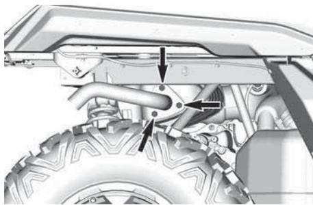
2. Retire el tubo de escape, la junta (deséchela) y el supresor del silenciador.
