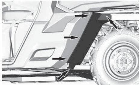
**Desmontaje de la tapa de la CVT**
