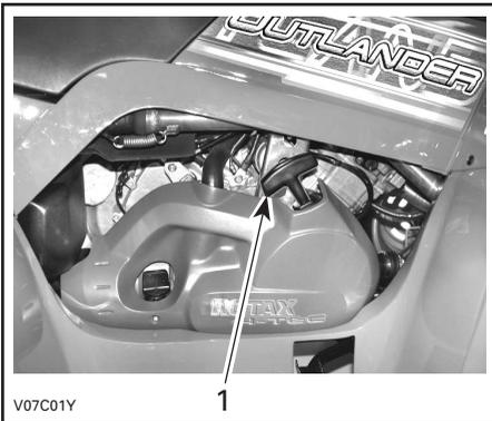
1. Halten Sie den Griff des manuellen Starters sicher fest und lassen Sie den Motor an
