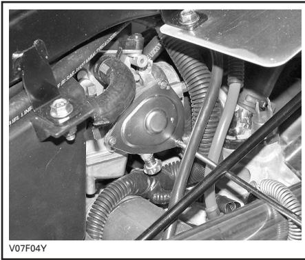
Führen Sie die Sprühspitze der Schmiermitteldose in das Ende des Gaszugreglers.
