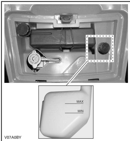
Wenn das Fahrzeug auf einer ebenen Fläche abgestellt ist, sollte sich der Kühlflüssigkeitsstand zwischen der MIN.- und MAX.-Markierung auf dem Kühlflüssigkeitsbehälter befinden.
