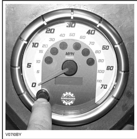
Wenn Sie die Anzeigewahltaste noch einmal drücken, schaltet die Anzeige auf den Zeitzähler um. Drücken Sie die Anzeigewahltaste noch einmal, um wieder zum Kilometerzähler zurückzukehren.
