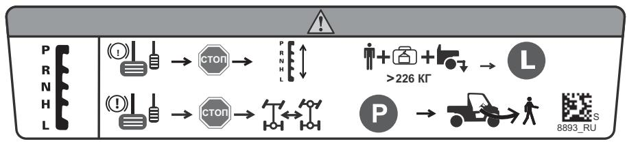
**Буксировка и нагрузка, приходящаяся на сцепное устройство — предупреждающая пиктограмма**
