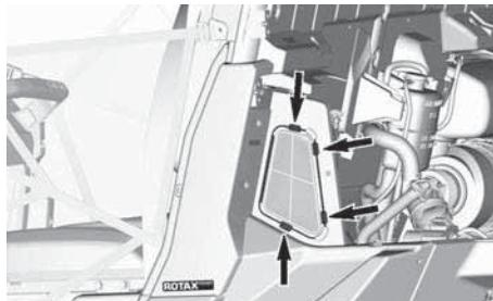
3. Снимите воздушный фильтр вариатора.
