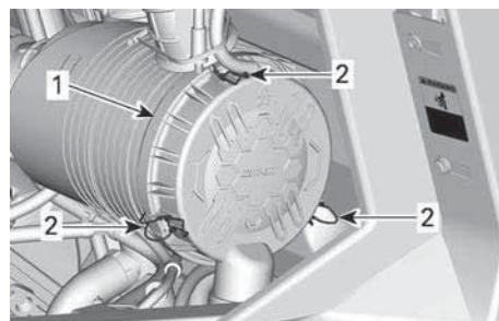
1. Крышка корпуса воздушного фильтра
