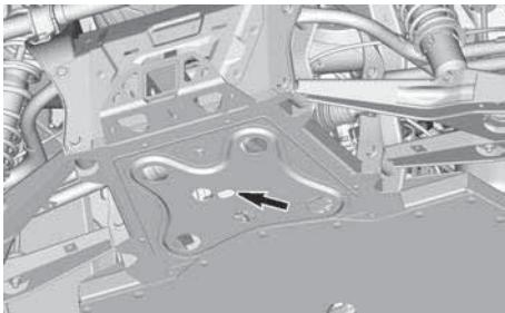
**ОКНО ДОСТУПА К ПРОБКЕ СЛИВНОГО ОТВЕРСТИЯ**
