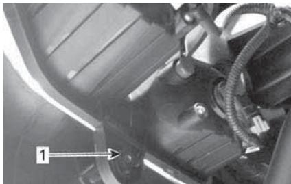
1. Регулировочный винт
