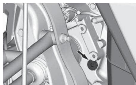
4. Выверните пробку заливного отверстия.
