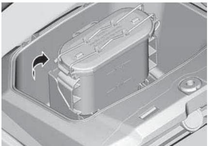
При необходимости долейте жидкость гидропривода сцепления. **Не допускайте перелива.**
