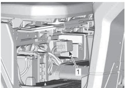
1. Задний вторичный блок предохранителей
