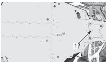
1. Область пробки сливного отверстия коробки передач
