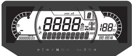
Отображает положение передач:
