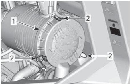
1. Крышка корпуса воздушного фильтра
