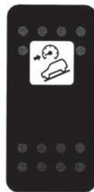
Функция помощи при спуске с горы (HDC) должна использоваться для обеспечения плавного и контролируемого спуска с крутой горы без необходимости нажимания на педаль тормоза.
