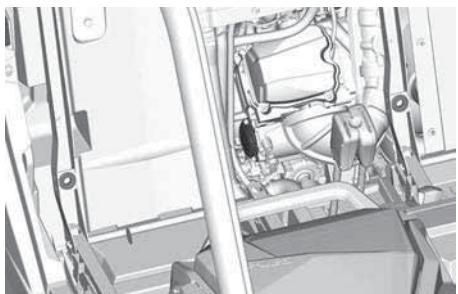
3. Снимите крышку масляного фильтра.
