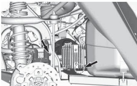
**МЕСТОПОЛОЖЕНИЕ КРЕПЕЖНЫХ ЭЛЕМЕНТОВ ОПОРЫ РЕГУЛЯТОРА НАПРЯЖЕНИЯ**
