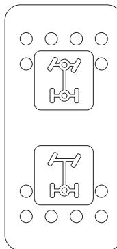
С помощью этого переключателя можно выбирать режим 2-колесного или полного привода, когда транспортное средство остановлено.
