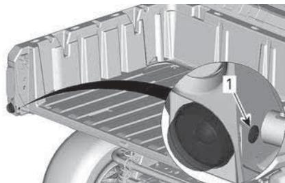
1. Винт крепления рассеивателя
