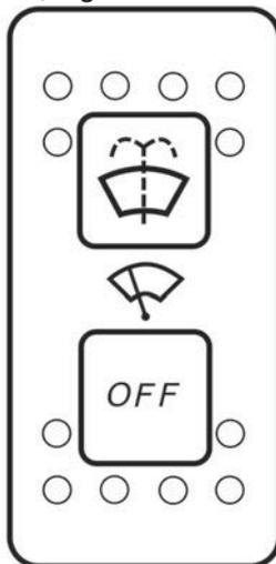
Ce commutateur sert à activer les positions Arrêt, Balayage ou Balayage avec lavage.
