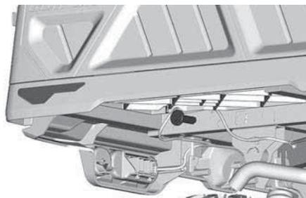
3. Insérez un crochet S dans le trou de l'axe.
