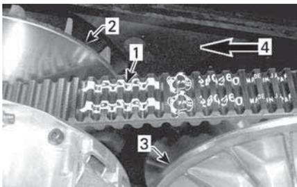
1. Flèche imprimée sur la courroie
