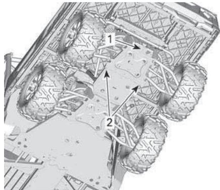
1. Point de levage sous le crochet d'attelage
