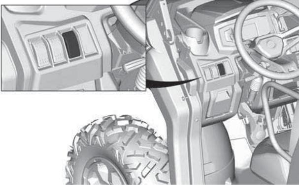
L'utilisation intensive du plateau motorisé peut causer la désactivation temporaire des disjoncteurs intégrés.
