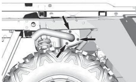
2. Déposez le tuyau d'échappement, le joint (mettre au rebut) et le pare-étincelles
