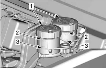
1. Depósitos de líquido de frenos
