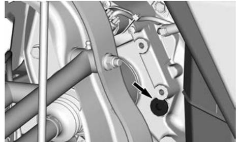
4. Retirez le bouchon de remplissage.
