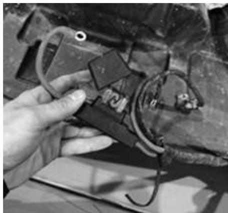
2. Vérifiez le fusible à l'aide d'un testeur de continuité.
