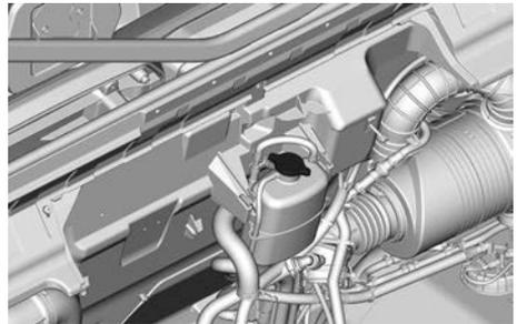
4. Vérifiez que le système de refroidissement est rempli jusqu'à la ligne de capacité maximale.
