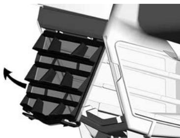
Lavez le filtre à air avec de l'eau tiède et du savon doux. Éliminez l'excès d'eau et laissez sécher à l'air avant de les réinstaller.
