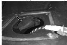
5. Remova a tampa da caixa de fusíveis e substitua o fusível danificado. Reinstale todas as peças que foram removidas.
