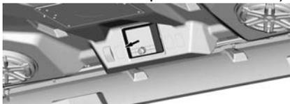
2. Remova e guarde os quatro parafusos M4 x 12 que prendem a unidade principal, conforme mostrado a seguir.
