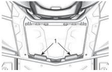
Dispositivo di chiusura del vano bagagli posteriore
