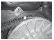
Porzione più bassa delle ruote dentate con la superficie esterna della cinghia di trasmissione
