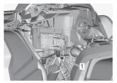
Tubo di scarico all'entrata dell'alloggiamento del filtro dell'aria.
