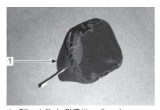
1. Filtro dell'aria CVT (tipo slip-on)
