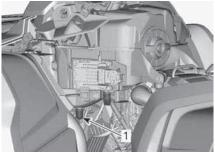
1. Tubo di scarico del filtro dell'aria Pulizia e lubrificazione del filtro dell'aria del motore
