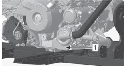
1. Bouchon de vidange du liquide de refroidissement
