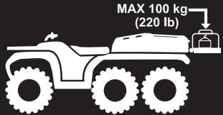
**NE JAMAIS dépasser la capacité de charge de 100 kg (220 lb) sur le hayon.**
