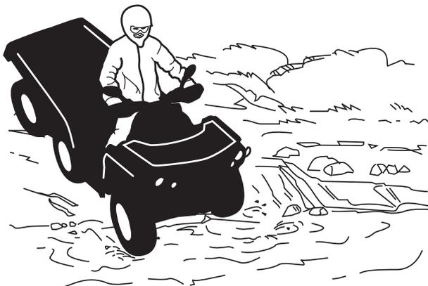
Des freins mouillés réduisent la capacité de freinage. Après être sorti de l'eau, de la neige ou de la boue, actionnez les freins plusieurs fois pour que la chaleur de la friction sèche les freins. Prévoir davantage de distance pour freiner.
