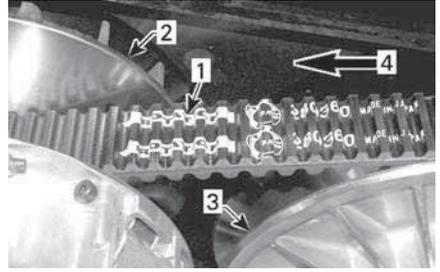
1. Flèche imprimée sur la courroie
