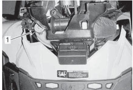
1. Bouchon du réservoir de liquide de refroidissement du moteur
