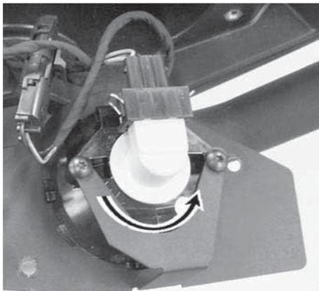
5. Retirez la douille de l'ampoule du feu arrière.
