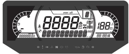
Diese Anzeige zeigt die Getriebestellung an:
