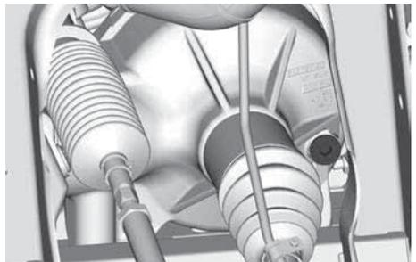
3. Entfernen Sie den Einfüllstopfen.
