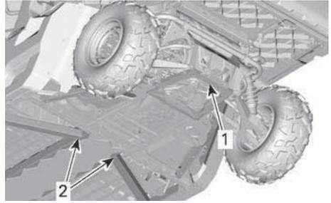
1. Hebestelle unter der Schutzplatte
