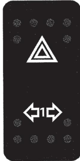
Dieser Schalter löst alle Blinker gleichzeitig aus. Zu verwenden, wenn das Fahrzeug steht und angezeigt werden soll, dass es den Verkehr vorübergehend blockiert.
