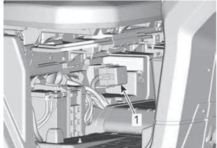
1. Hinterer zweiter Sicherungskasten
