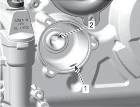
1. Einlass-Bohrung der Ölpumpe zum Ölfilter
