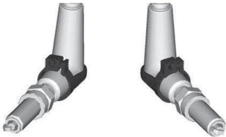
5. Снимайте провода свечей зажигания, осторожно повернув колпачок и сняв его со свечи.
