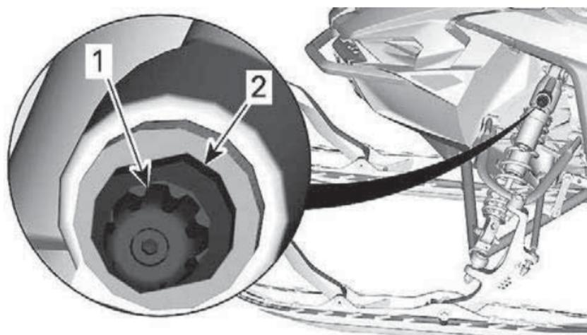
1. Регулировка характеристик хода сжатия на низкой скорости (рукоятка)
