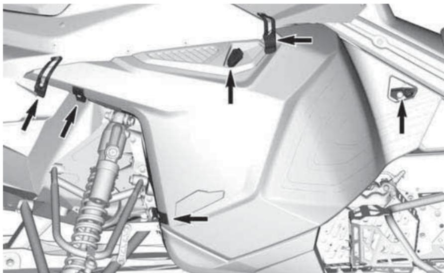
2. Поднимите боковую панель, чтобы вывести фиксаторы из зацепления.
