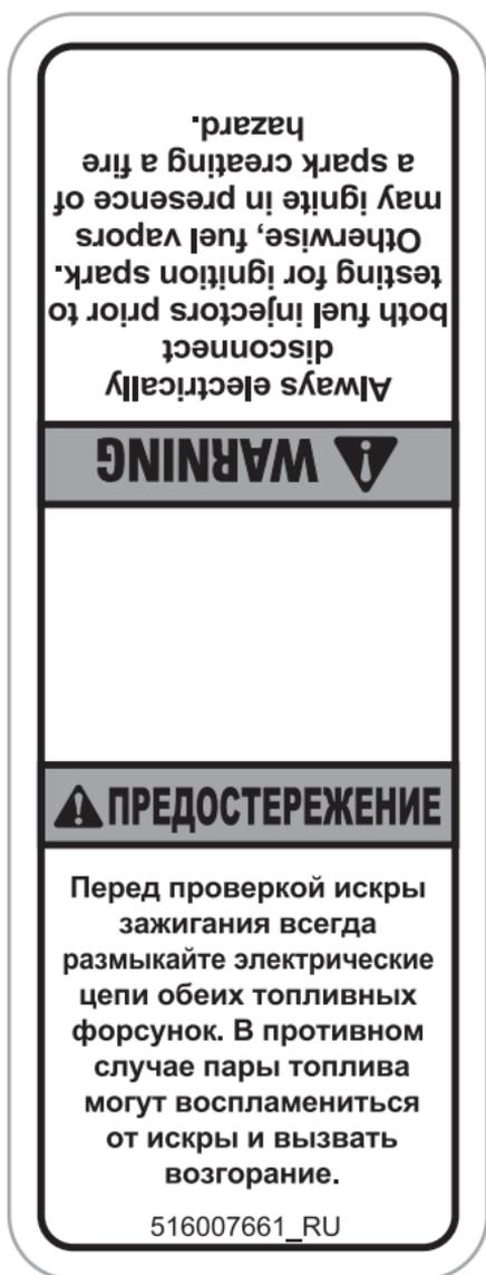
ОТСОЕДИНИТЕ ТОПЛИВНЫЕ ФОРСУНКИ — ПРЕДУПРЕЖДАЮЩАЯ НАКЛЕЙКА
