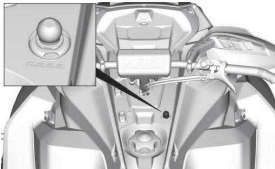
Для эксплуатации снегохода необходимо надежно подсоединить колпачок шнура безопасности к контактной поверхности выключателя.
