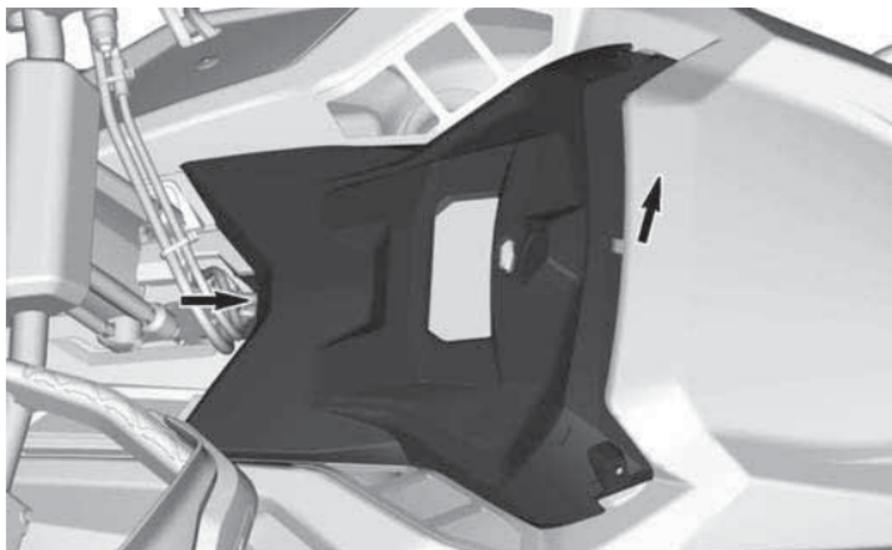
3. Отсоедините разъем приборной панели и снимите опору.
