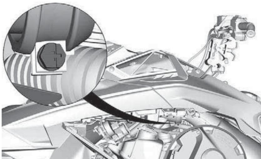
7. Выверните болты крепления верхнего модуля корпуса (капота) с обеих сторон.
