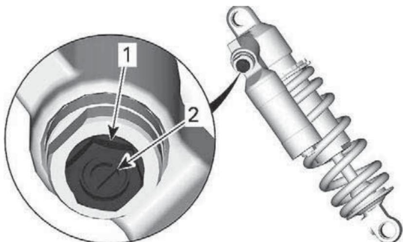
1. Регулировка характеристик на высокой скорости (гайка)
