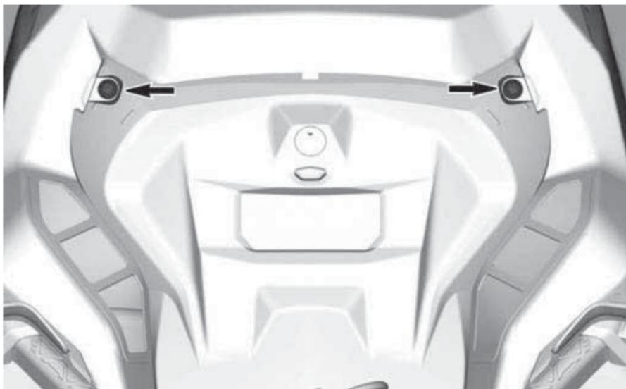
2. Поднимите переднюю часть опоры панели приборов, а затем сместите ее вперед, чтобы снять.
