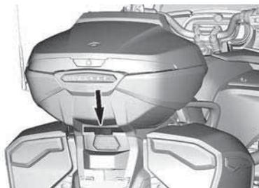
4. Levante ligeramente el compartimento de almacenamiento y deslice la mano por debajo para desconectar el conector situado cerca del asiento del pasajero.
