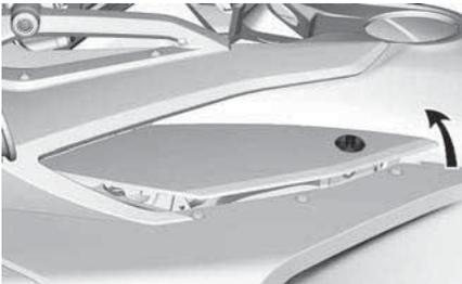
LEVANTE LA PARTE TRASERA DE LA CUBIERTA
