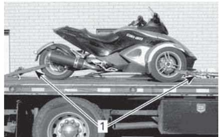
**TÍPICO - VEHÍCULO ORIENTADO HACIA EL REMOLQUE**
