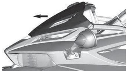
3. Afloje el tornillo de sujeción inferior de la punta de la consola.
