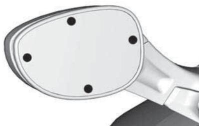
PUNTOS DE AJUSTE DE LOS ESPEJOS -
