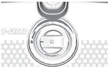
Si el pomo es difícil de girar, instale el asa moldeada incluida sobre el pomo para un mejor agarre. Este asa moldeada se encuentra en la pared del compartimento.
