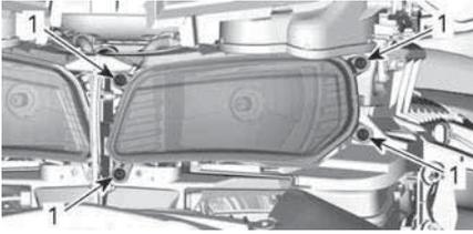
1. Vite di serraggio luce di posizione
