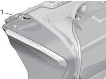
1. *Vite di fissaggio superiore*
