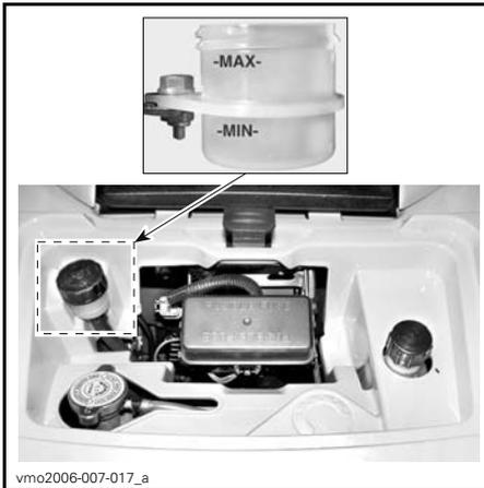
TYPICAL - BRAKE PEDAL FLUID RESERVOIR
