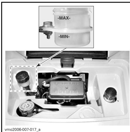
TÍPICO - DEPÓSITO DE LÍQUIDO DEL PEDAL DE FRENO
