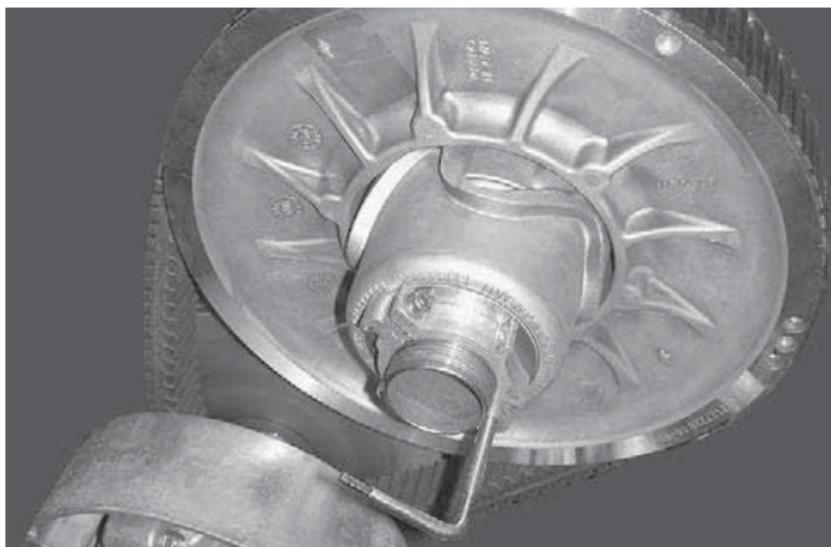
**TYPIQUE - ÉCARTEUR DE COURROIE INSTALLÉ SUR LE MOYEU DE RÉGLAGE**
