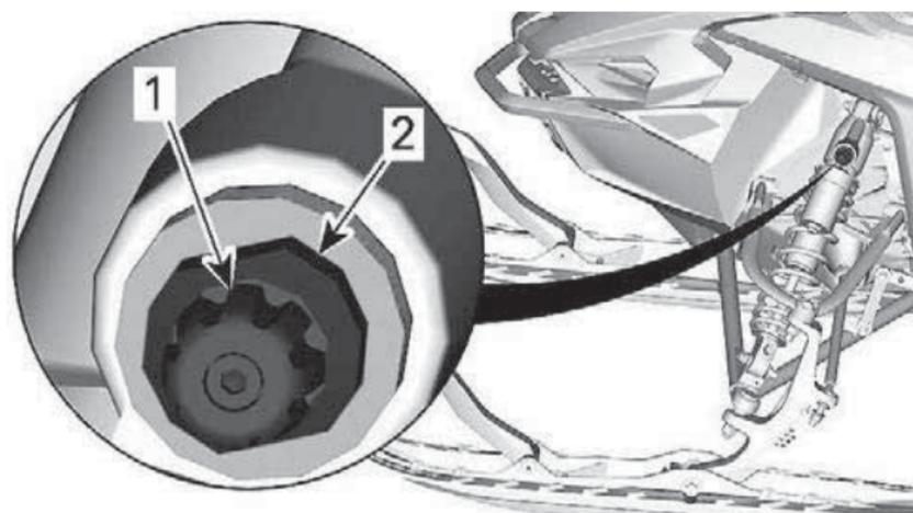
1. Dispositif de réglage de la compression à basse vitesse (bouton)
