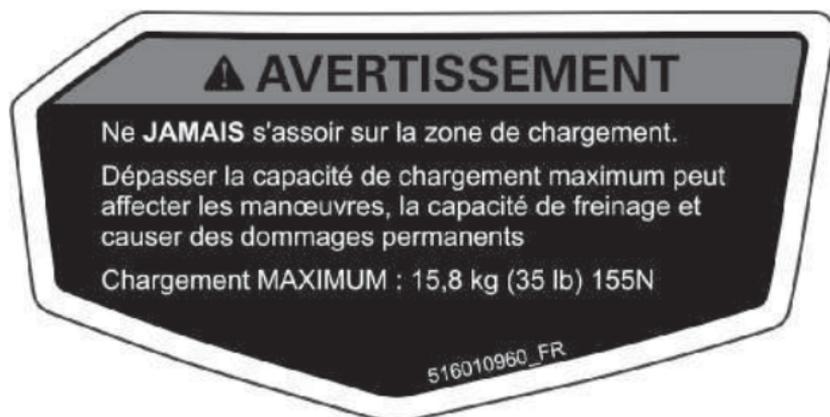
**CAPACITÉ DE CHARGE MAXIMALE - ÉTIQUETTE D'AVERTISSEMENT**
