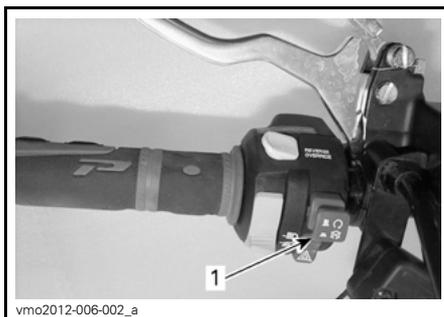
1. Interruptor de parada de emergência do motor
