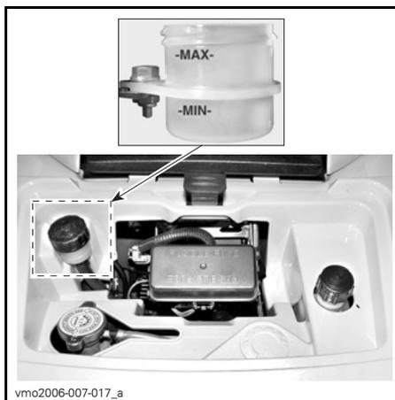
TÍPICA - RESERVATÓRIO DE FLUIDO DO PEDAL DE FREIO
