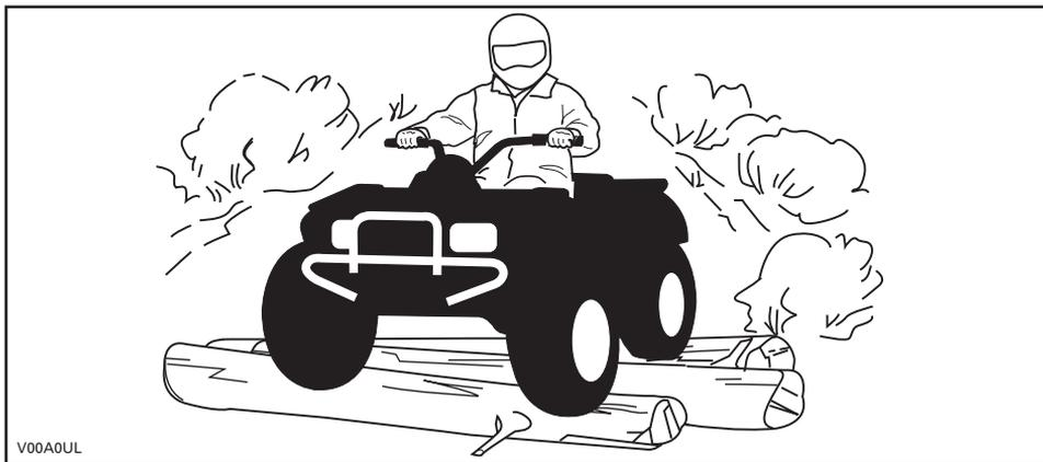
Embora o veículo tenha um sistema de suspensão adequado, existem “costelas de vaca” ou condições acidentadas do terreno que podem causar desconforto e até mesmo um machucado nas costas. Muitas vezes é necessário “levantar” ou dirigir em uma posição agachada. Reduza e deixe as pernas flexionadas absorverem parte da energia do impacto.
