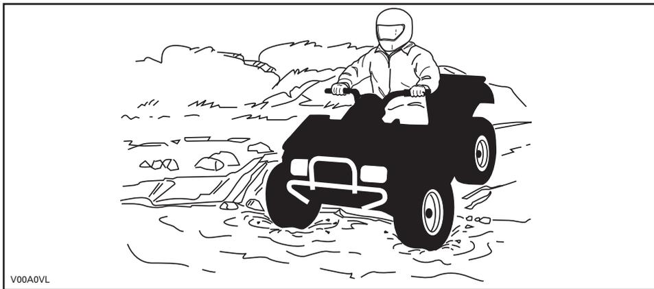
A água afeta a capacidade de frenagem do seu veículo. Certifique-se de secar os freios, aplicando-os várias vezes depois de sair da água. Em modelos de dois lugares a distância de frenagem do veículo pode ser afetada ao transportar um passageiro. Reduza prudentemente a velocidade quando estiver dirigindo com um passageiro. Considere uma distância maior para frenagem.
