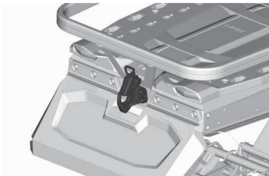
Per aprire il gancio, spingere e ruotare la maniglia per retrainere la piastra di bloccaggio.
