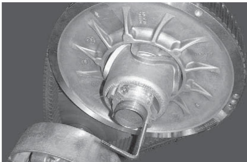
**ТИПОВОЙ ВАРИАНТ — ПРИСПОСОБЛЕНИЕ ДЛЯ РАЗВЕДЕНИЯ ШКИВА ВСТАВЛЕНО В РЕГУЛИРОВОЧНУЮ МУФТУ**
