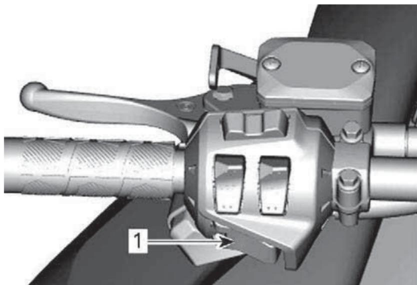
1. Кнопка запуска двигателя/включения электронного реверса
