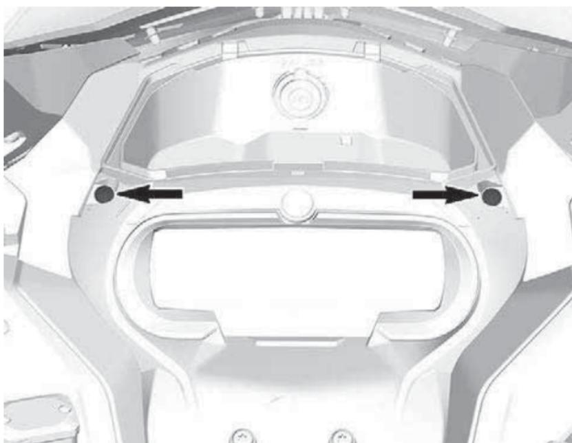
4. Поднимите переднюю часть опоры приборной панели, а затем сместите ее вперед, чтобы снять.
