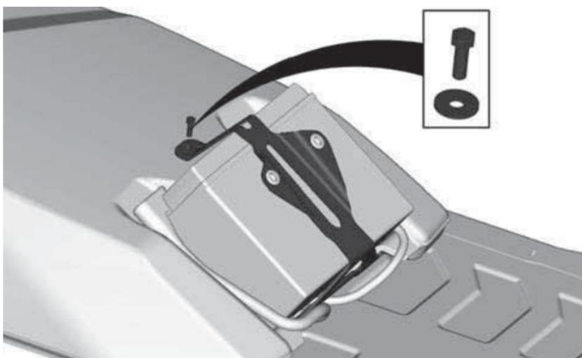
5. Снимите аккумуляторную батарею.
