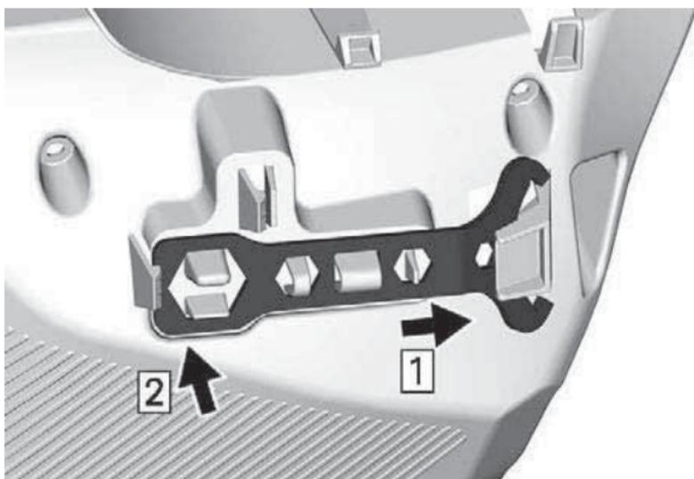
3. Вставьте короткий конец инструмента для разведения шкива и регулировки фар в отверстие.
