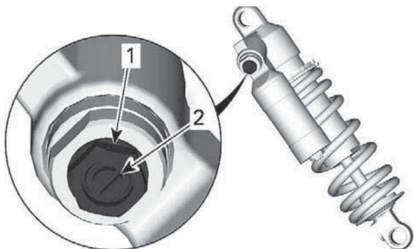
1. Регулировка характеристик на высокой скорости (гайка)
