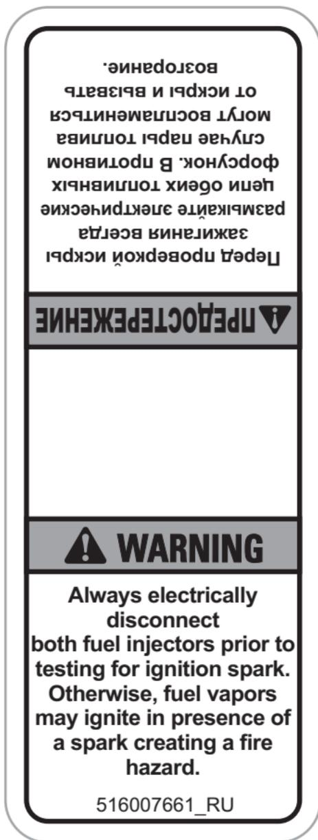
**ОТСОЕДИНИТЕ ТОПЛИВНЫЕ ФОРСУНКИ — ПРЕДУПРЕЖДАЮЩАЯ НАКЛЕЙКА**
