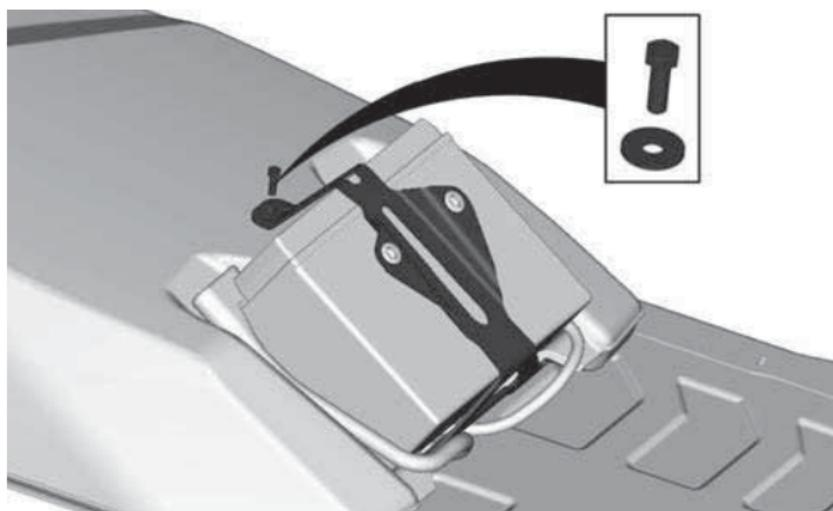
5. Снимите аккумуляторную батарею.
