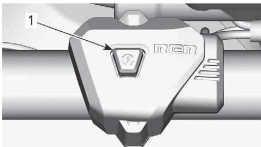
1. Кнопка запуска двигателя/включения электронного реверса
