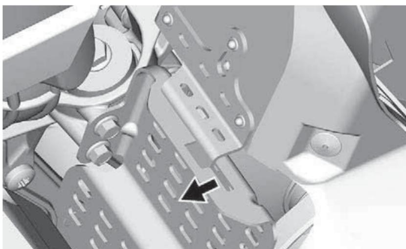
3. Установите заднюю часть кожуха на держатель и закрепите его с помощью проволоочного фиксатора.
