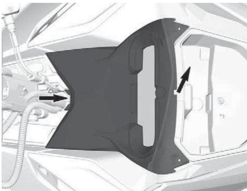
5. Отсоедините разъем приборной панели и снимите опору.
