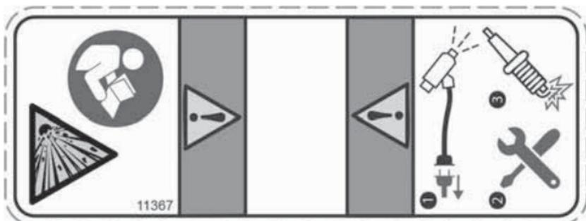
**ОТСОЕДИНИТЕ ТОПЛИВНЫЕ ФОРСУНКИ — ПРЕДУПРЕЖДАЮЩАЯ НАКЛЕЙКА**
