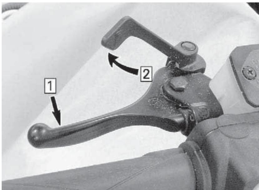
**ТИПОВОЙ ВАРИАНТ – ВКЛЮЧЕНИЕ СТОЯНОЧНОГО ТОРМОЗА**
