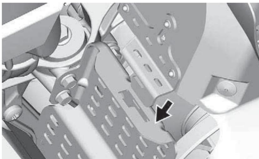
2. Нажмите на кожух ремня вариатора по направлению к двигателю, а затем в направлении передней части снегохода.
