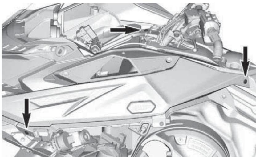
10. Снимите верхнюю панель корпуса.
