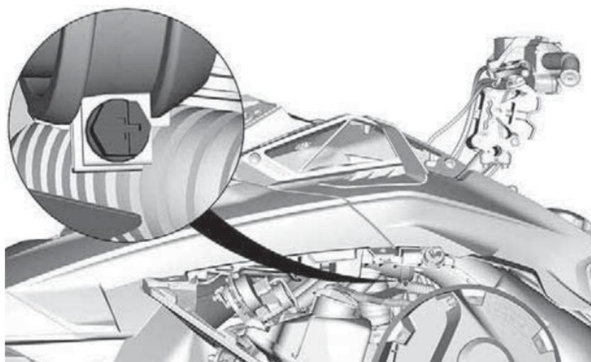
9. Выверните болты крепления верхнего модуля корпуса (капота) с обеих сторон.
