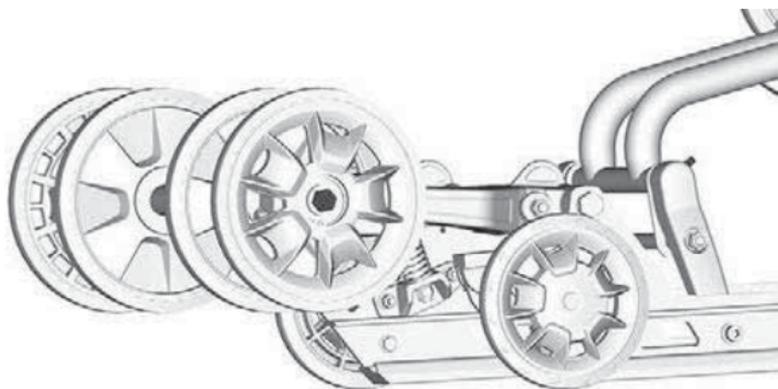
6. Serrez ou desserrez les 2 vis de réglage pour augmenter ou diminuer la tension de la chenille.
