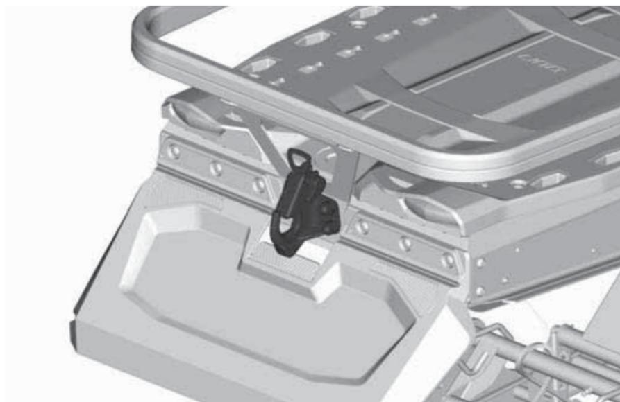
Pour ouvrir le crochet, poussez et tournez la poignée pour sortir la plaque de verrouillage.
