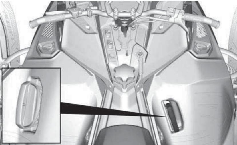
Type à rappel automatique situé côté droit de votre motoneige. Pour activer le mécanisme, tirez sur la poignée jusqu'à ce que vous sentiez une résistance, puis tirez avec force. Relâcher la poignée lentement.
