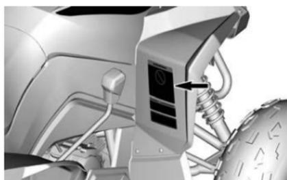
**Etiqueta de Presión de los neumáticos y carga máxima**
