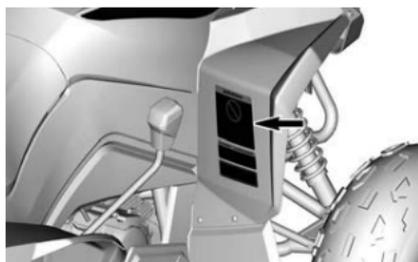
Étiquette : Pression des pneus et charge maximale
