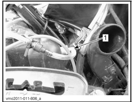
1. Entrada del filtro de aire del compresor de la suspensión ACS en la cubierta del alojamiento del filtro de aire
