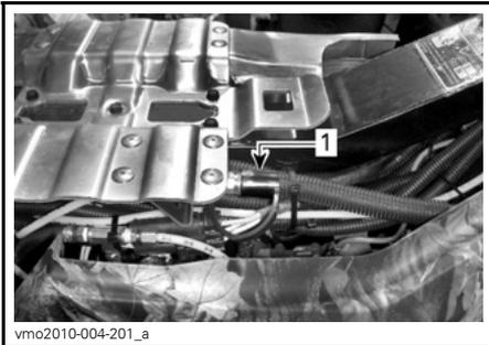
1. Acoplamiento del compresor
