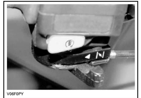
CHOKE GEÖFFNET, HEBEL IN UNBETÄTIGTER STELLUNG
