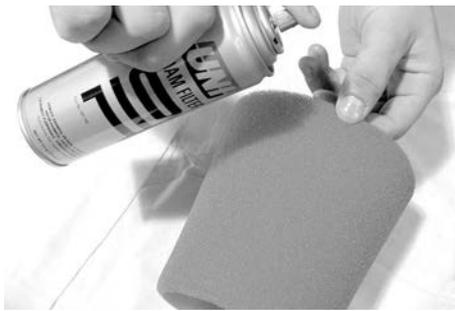
**TÍPICA - UNTE O ELEMENTO DE ESPUMA DO FILTRO COM ÓLEO**
