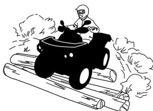
Embora o veículo tenha um sistema de suspensão, existem “costelas de vaca” ou condições acidentadas do terreno que podem causar desconforto e até mesmo um machucado nas costas. Muitas vezes é necessário “levantar” ou dirigir em uma posição agachada. Reduza e deixe as pernas flexionadas absorverem parte da energia do impacto.
