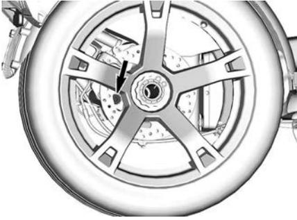
1. Tournez la roue arrière jusqu'à ce que le bouchon de remplissage puisse être atteint par une ouverture du frein à disque.
