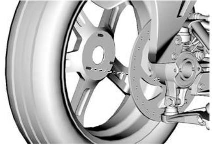
2. Posez la rondelle conique et le contre-écrou central de la roue.
