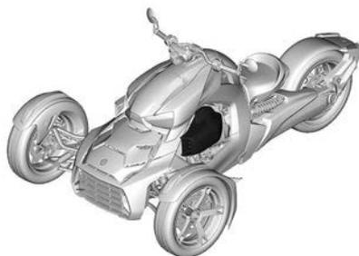
Le couvercle de service gauche doit être retiré pour accéder au filtre à air du moteur.
