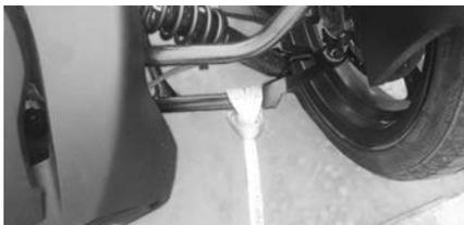
3. Attachez les courroies au câble de treuil.
