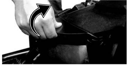
5. Tirez le carénage vers l'avant pour le dissocier du véhicule.
