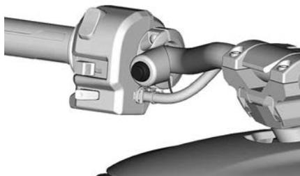
Le régulateur de vitesse permet de maintenir une vitesse constante pendant la conduite du véhicule. Il fait
