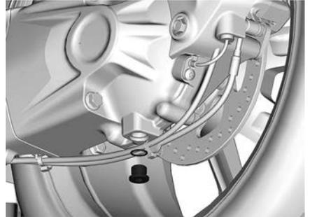
5. Retirez le bouchon de remplissage.
