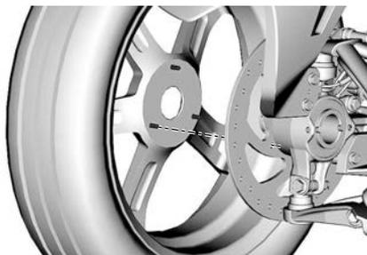
2. Montare la rondella conica e il dado della ruota center lock.
