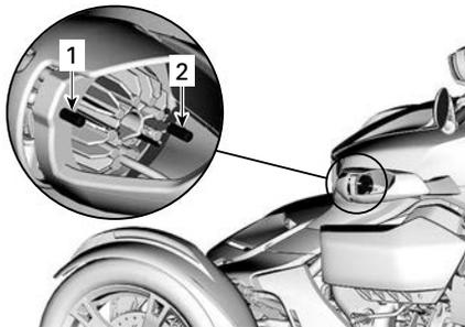
1. Dispositivo per la regolazione orizzontale del faro (a destra e a sinistra)
