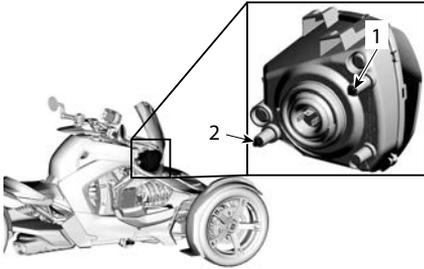
1. Dispositivo per la regolazione orizzontale del faro (a destra e a sinistra)
