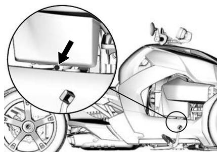
2. Aprire il coperchio di manutenzione destro, fare riferimento ad *Apertura del coperchio di manutenzione destra*.
