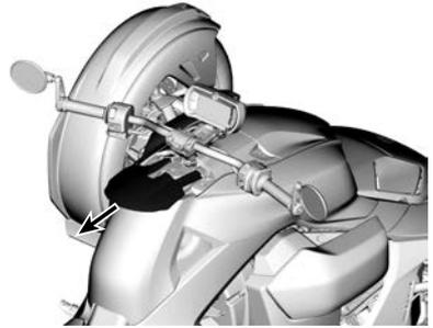
4. Allentare lentamente il tappo del serbatoio carburante in senso antiorario per rimuoverlo.
