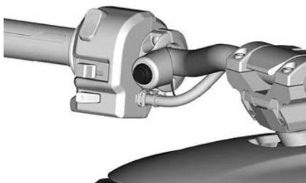
Il pulsante cruise control permette di mantenere una velocità costante durante la guida. Questo aumenterà o diminuirà i giri del motore in base alla necessità.
