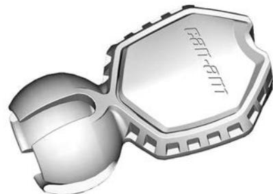
Ogni chiave contiene un circuito elettronico che include un chip specificamente pre-programmato che viene letto via radio frequenza dal sistema immobilizer per consentire l'avvio del motore.
