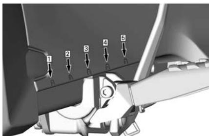
Dopo aver effettuato la regolazione dei poggiapiedi e del pedale del freno, BRP raccomanda al guidatore di sedersi sul veicolo nella posizione di guida per determinare se è la più adeguata e la più comoda. Inoltre il guidatore deve verificare che il pedale del freno possa essere premuto fino al suo finecorsa.
