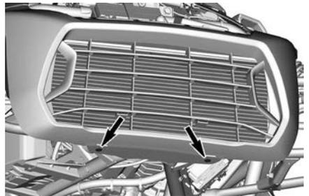
4. Sollevare l'estremità delle estensioni della fascia anteriore per rilasciare le linguette di blocco posteriori.
