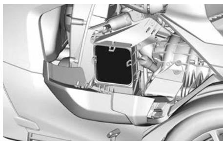
1. Rimuovere la vite che fissa il fondo dell'alloggiamento del filtro dell'aria CVT.
