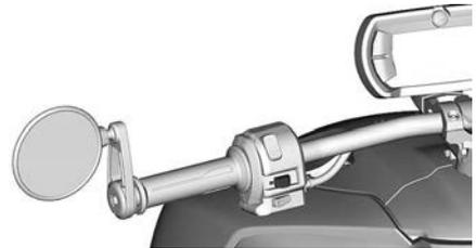
Si spegne automaticamente dopo una normale svolta ma potrebbe essere necessario spegnerla manualmente dopo una leggera curva o un cambio di corsia.
