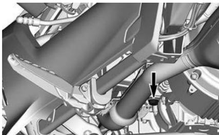
4. Sistemare una vaschetta di raccolta sotto la zona del tappo di scarico magnetico della scatola del cambio.
