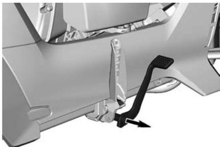
4. Abbassare il poggiaiedi e verificare che il guidatore possa premere completamente il pedale del freno.
