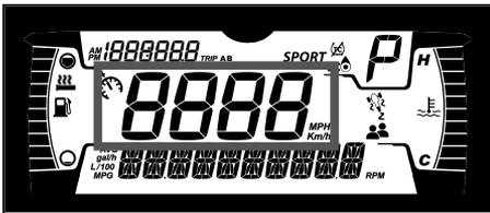
Visualizza la velocità del veicolo in KM/h o in MPH.
