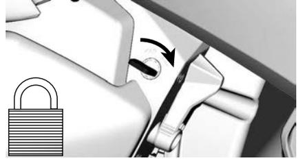
Per sbloccare la leva della posizione di stazionamento, girare la chiave in senso antiorario.
