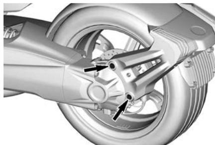
7. Rimuovere il dado della ruota center lock e la rondella conica.
