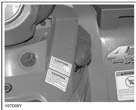
Per cambiare la posizione di trasmissione, fermare completamente il veicolo e poi muovere la leva nella posizione desiderata. Non forzare la leva. Se non fosse possibile muovere la leva, accelerare e rilasciare immediatamente l'acceleratore, poi attendere che il motore ritorni al minimo e riprovare.
