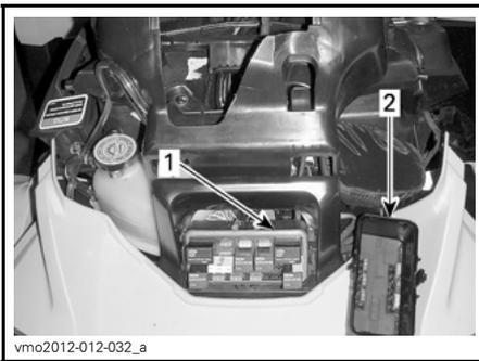
1. Vorderer Sicherungskasten
