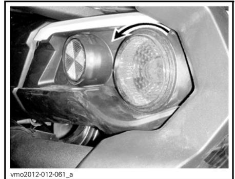
**RÜCKLEUCHE ZUM ENTFERNEN GEGEN DEN UHRZEIGERSINN DREHEN**
