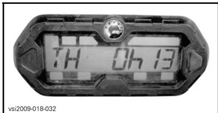
Pressione e **SEGURE** o botão seletor de display por 2 segundos para zerar o contador de horas.
