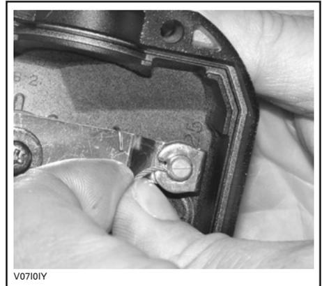
Remova a proteção lateral do corpo de acelerador.
