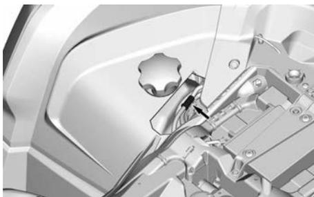
1. Desenchufe las mangueras del filtro por el arco de la rueda trasera derecha.
