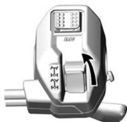
**MODO 4WD - TÍPICO****Selector de modos de conducción**
