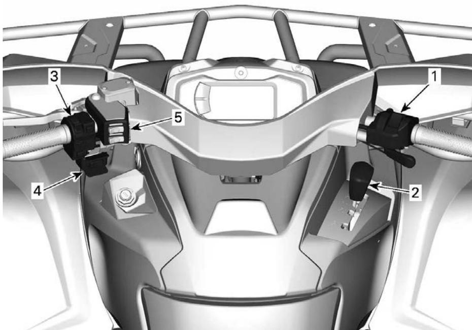
1. Alloggiamento del comando della leva dell'acceleratore
