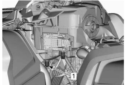
1. Tubo di scarico del filtro dell'aria
