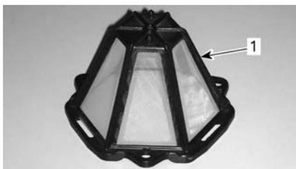
1. Filtro dell'aria CVT (tipo clip-on)
