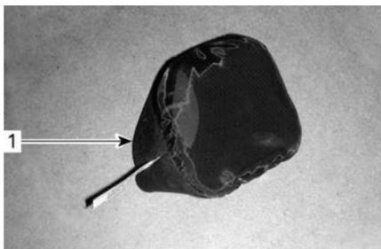
1. Filtro dell'aria CVT (tipo slip-on)
