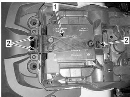
1. Fascetta di fissaggio della batteria
